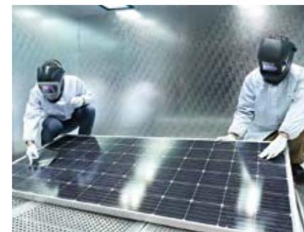
製品の寿命が長いことにより、地球資源の搾取を減らすことができます。試験所で行われる信頼性テストでは、厳密なテスト方法を使用して、実際の環境条件下でモジュール性能のシミュレーションを行い、期待される品質と信頼性を満たしているかどうかを評価します。
